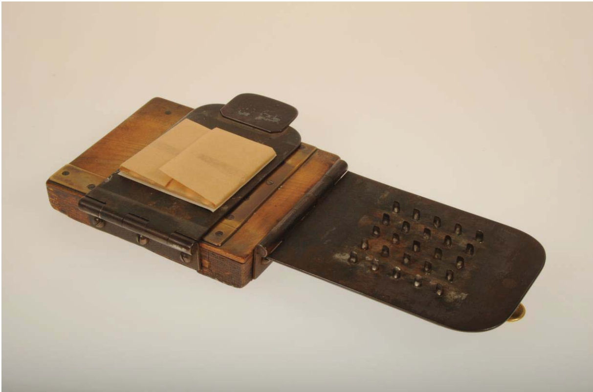
Abb. 9: Werkzeug zum Herstellen der Innenverpackung (Knopfkarten und Seidenpapiere). Vgl. Abb.-6. Zu Erkennen in der untere Bildhälfte, Ecke links.
