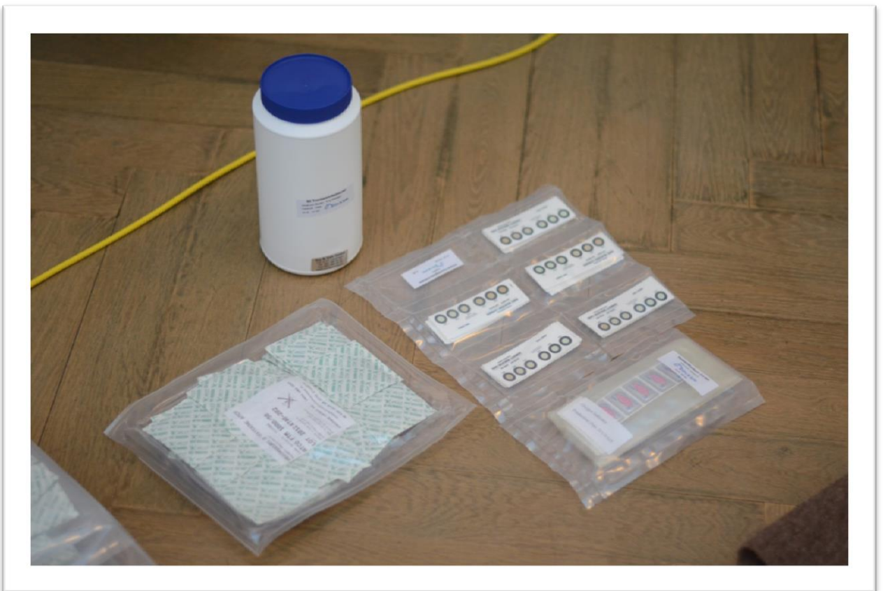
Présentation des 4 éléments à introduire dans la poche (absorbants d'oxygène, gel de silice, testeurs d'oxygène et indicateurs d'humidité)
