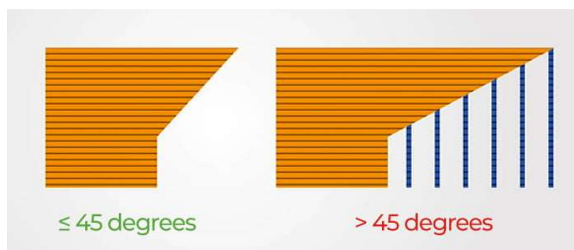
Die 45-Grad-Regel gilt für den 3D-Extrusionsdruck
